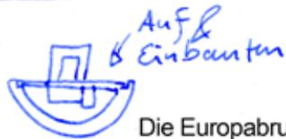
Um die Schüsseln unter Einsatz von Druckluft und einem Kran aus der Form heben zu können stehen unten in der Mitte und am oberen Rand Anker aus Baustahl über, die aus den Innenformen entsprechend ausgespart werden müssen
